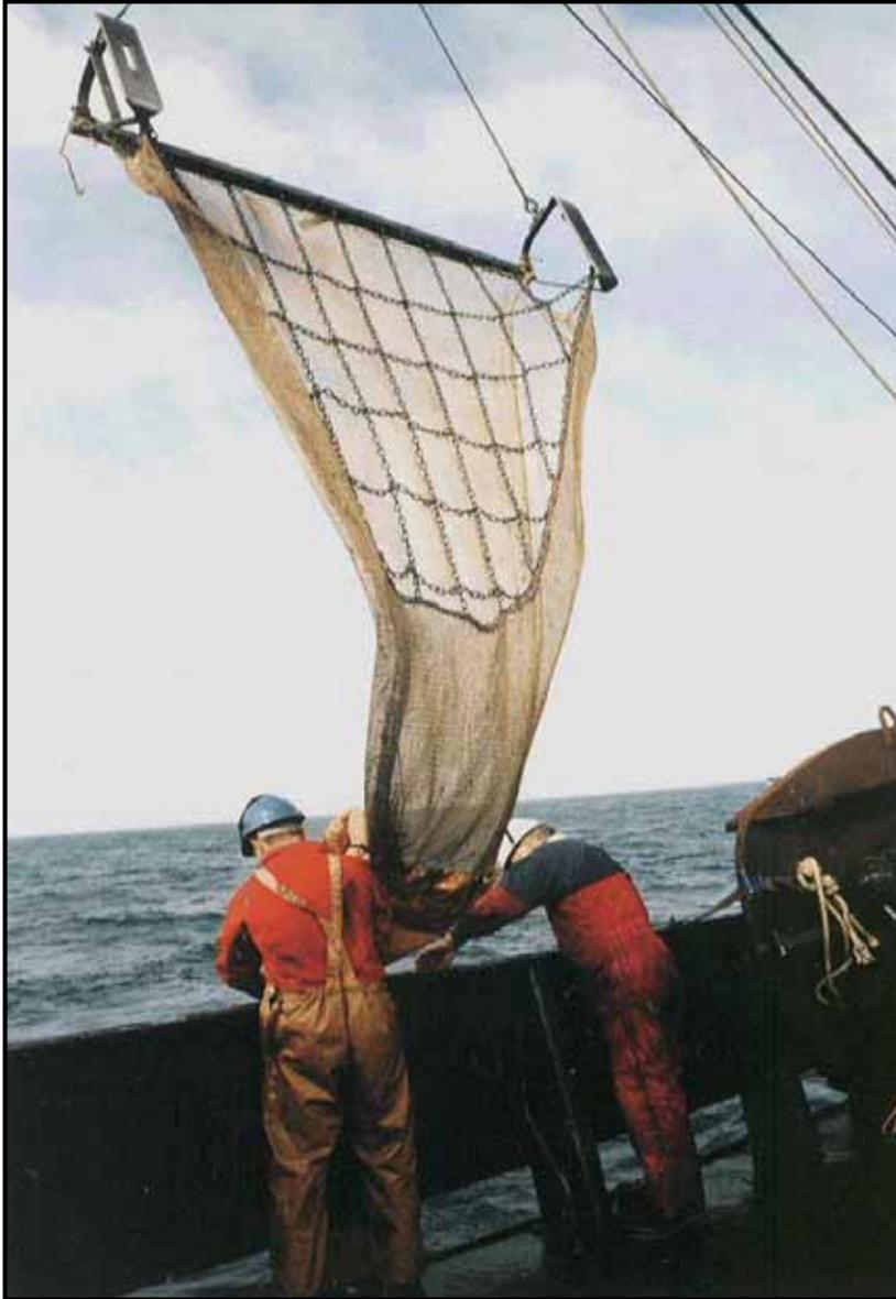
Figure 6.3.1.1.1. 2m beam trawl.
